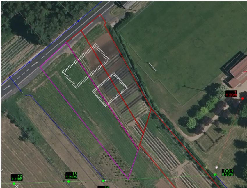
L'ancienne station d'épuration, devenue obsolète, se trouve dans la zone inondable et doit être impérativement remplacée et déplacée. La future station sera une station de traitement par Bio Filtres de type plantation de roseaux, bien plus écologique et beaucoup moins impactante sur le plan visuel.
